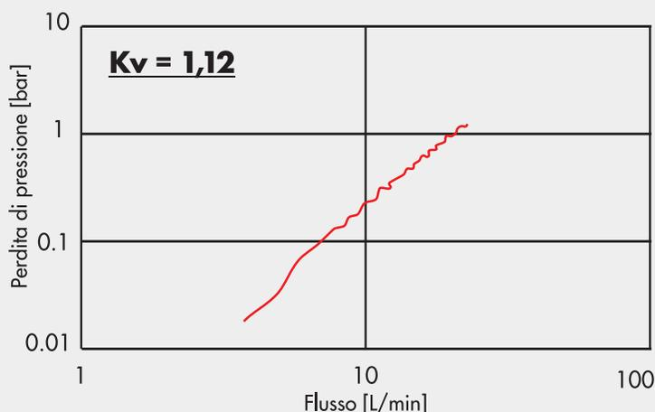
Il valore kVS è influenzato dal tipo di controprezzo utilizzato e dalla configurazione geometrica del distributore. Per questo scopo, riceverete da noi un disegno con le dimensioni di collegamento necessarie.
